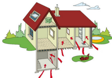
Les voies d'entrée du Radon
